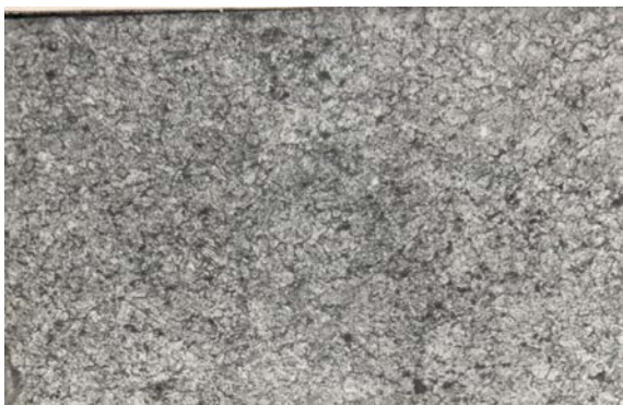
Фиг. 3. Мартензито-трооститна структура след закаляване на стомана С45, \times 250
