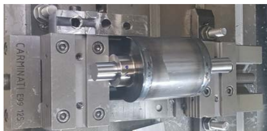
Фиг. 5. Изглед на установката за изработване на отворите в главините и захифтоването им спрямо вала.
