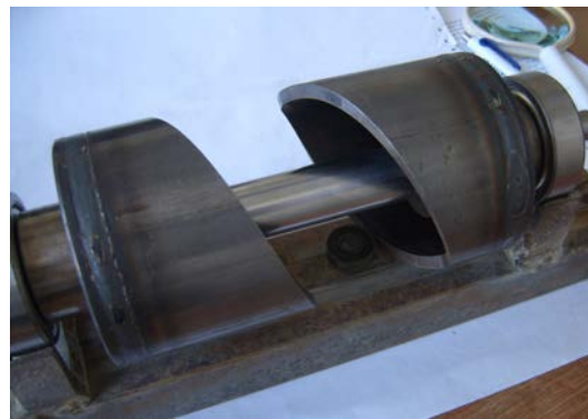
Фиг. 9. Изглед на изработената гърбица, поставена на стойка за предстоящи изследвания.
