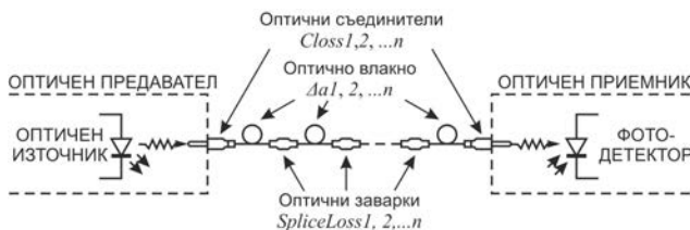
Фиг. 2. Модел на загубите в линията: в оптичните съединители, в оптичните заварки и в оптичното влакното
