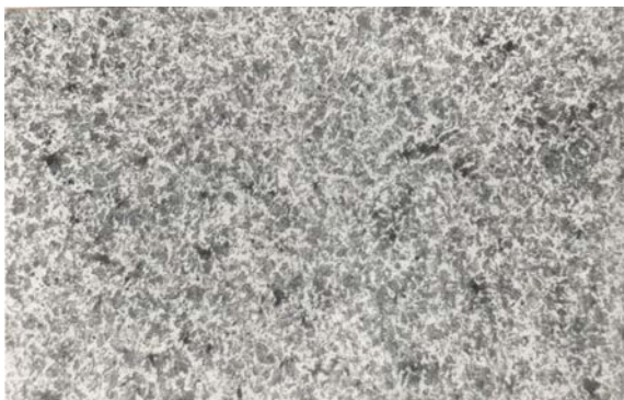
Фиг. 2. Стомана С45 след термоциклично обработване, \times 250
