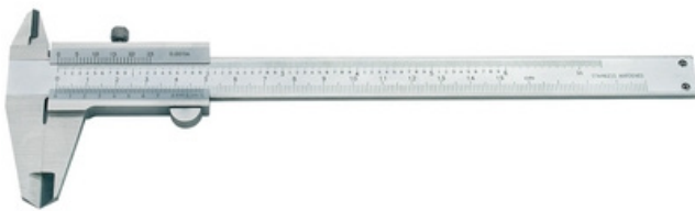
Фигура 1. Общ изглед на универсален шублер Фигура 2. Увеличено изображение на скалата (нониуса) на шублер
