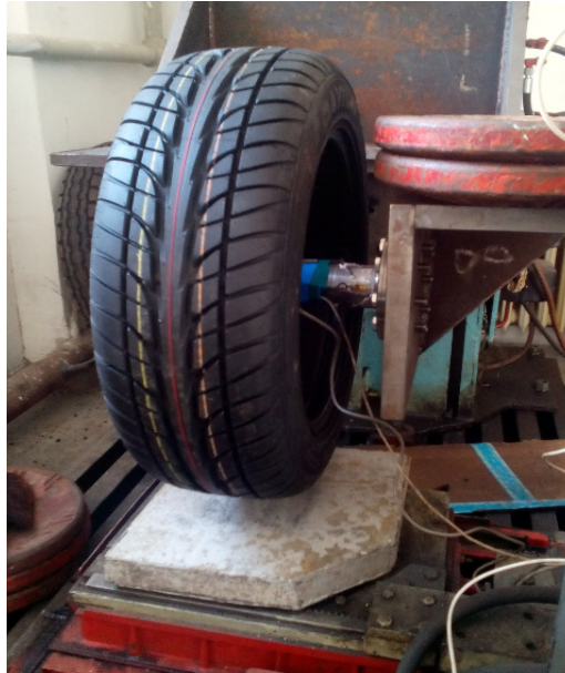
Фигура. 4. Изпитваните плочи с различни пътни настилки: а) синтетична пътна настилка; б) асфалт; в) бетон.
