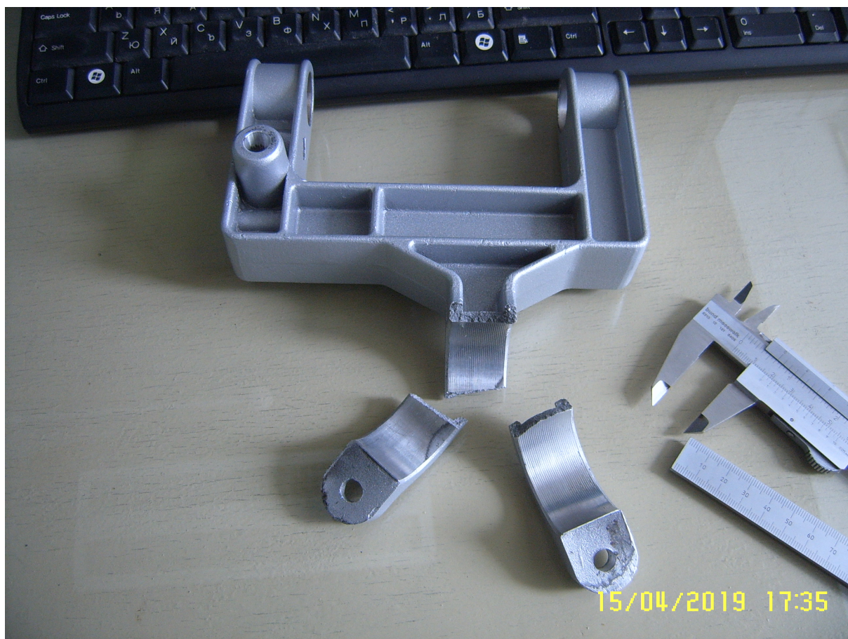
Фигура 3. Изглед на счупената носеща конзола за ръчна електрическа бормашина
