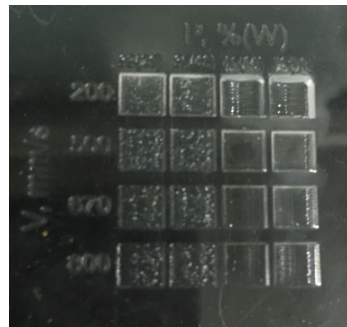
Фигура 3б. Реакция на материала (Плексиглас-8мм) при използване на технологична карта за лазерно гравирание при фокус= -4 мм.
