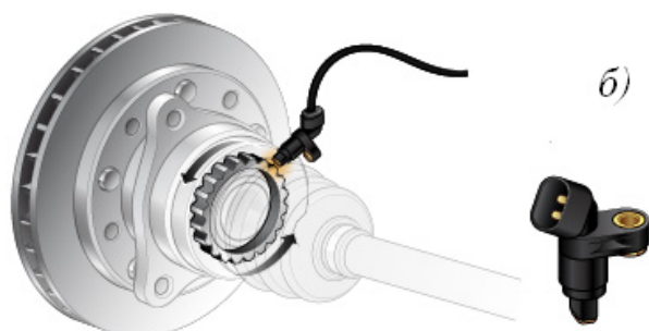
Фигура 7. Сензори за положението на разпределителния вал (а) и за определяне на скоростта на въртене на автомобилното колело (б)
