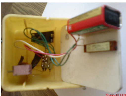
Фигура 8. Устройство на учебния тестер за тестване на бобини
