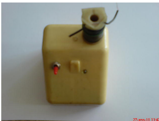
Фигура 8. Учебен тестер, тестване на бобина за реле
