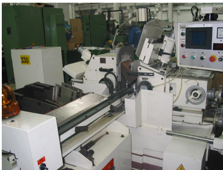
Фигура 8. Вътрешно-шлифоваща машина Palmary PC 18 NC- Тайван
