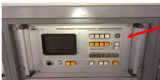
Фигура 3. Апаратура на фирмата „Роботрон“ - локатор на повреди
