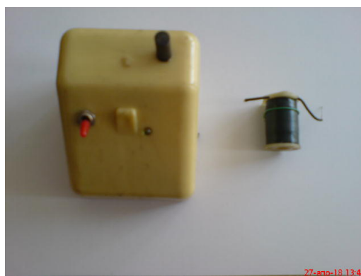
Фигура 7. Учебен тестер, общ вид, и тествана бобина за реле
