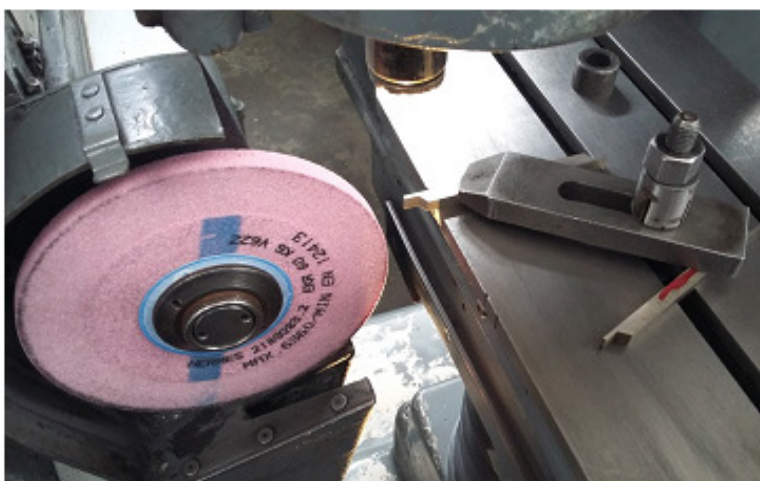
Фигура 8. Изгледи на установка за профилиране на стругарски нож и на профилирани ножове
