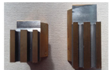
Фигура 8. Изгледи на установка за профилиране на стругарски нож и на профилирани ножове
