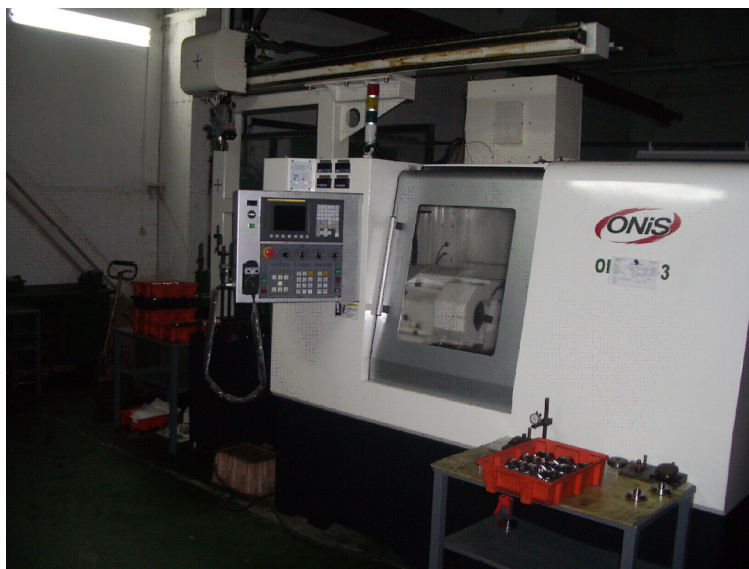
Фигура 7. Вътрешно-шлифоваща машина Palmary OIG-150-3-CNC -Тайван
