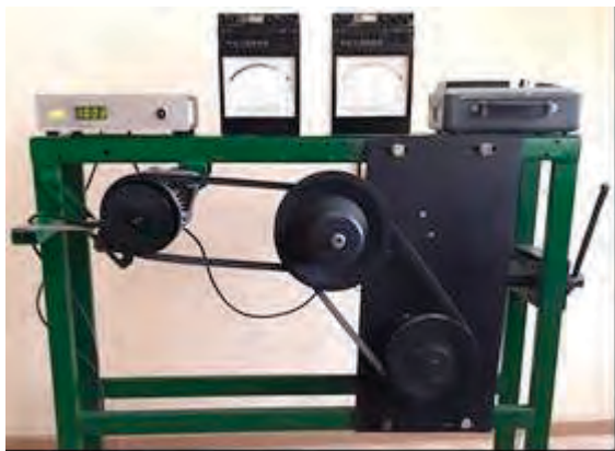
Фиг. 4. Общ вид на лабораторна установка за изследване на клиноремъчен вариатор
