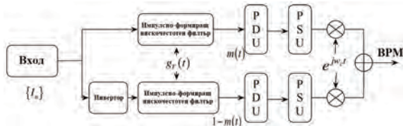
Фиг. 2. Схема на двоична поляризационна модулация (BPM)
