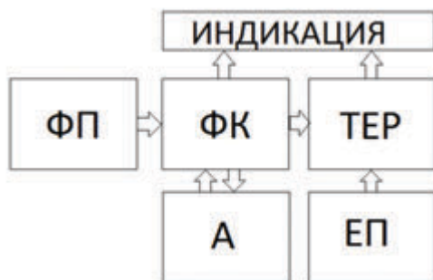
Фиг. 1. Блокова схема на автономната термоелектрична система
