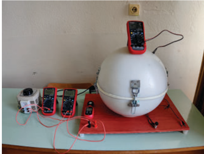
Фиг. 5. Фотометрична сфера за измерване интензитета на светлината
