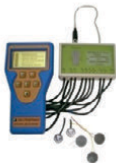
Фиг. 3. Измервател на плътността на топлинния поток
