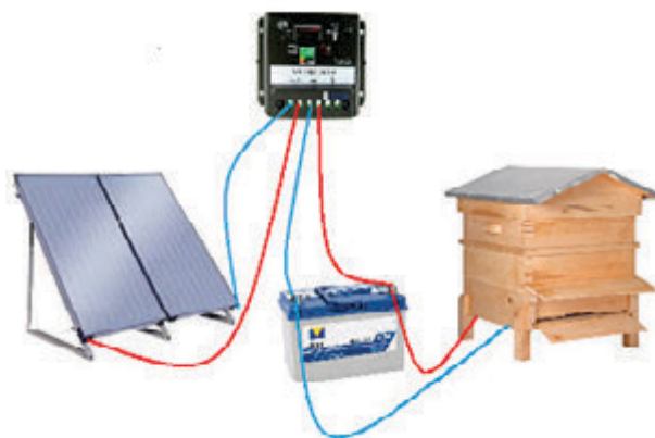
Фиг.7. Компоненти на автономната система за управление на температурата в пчелен кошер
