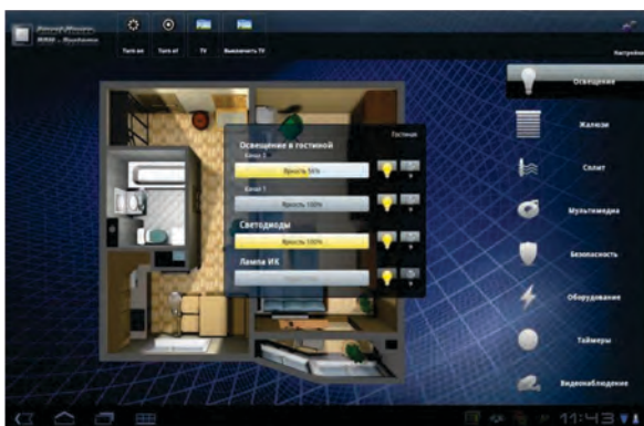
Фиг. 8. Автоматично управление на яркостта на осветлението в жилищен дом
