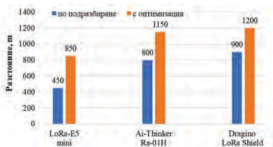
Фиг. 3. Сравнение по критерий разстояние на комуникация (надеждно предаване на пакетите)
