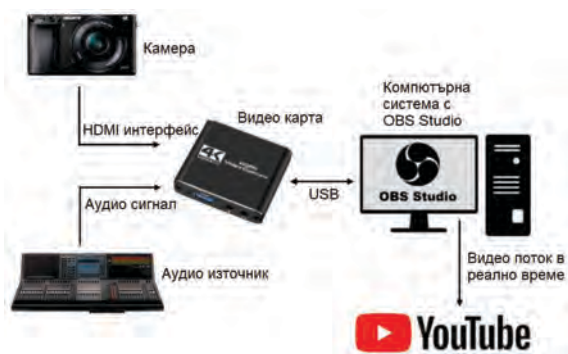
Фиг. 3. Блокова схема на свързване на използваното оборудване към OBS Studio за поточно предаване на живо
