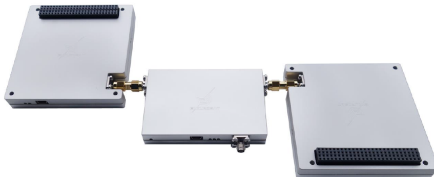
Фиг. 4.3. Схема на свързване на EnduroSat сателитна комуникационна система за обучение
