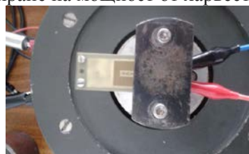
Фиг. 4.46. Монтиране на харвестера
