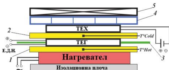
Фиг. 2.1. Конструкция на термоелектрическа батерия: 1, 2 – медни термопроводи; 3 – изолираща пластина от гетинакс; 4 – радиатор на горещата страна на ТЕХ; 5 – вентилатор за разсейване на топлинна.
