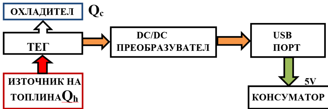
Фиг. 3.11. Блокова схема на системата за генериране на електрическо захранване под действието на източник на топлина.
