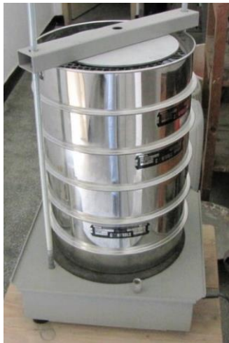
Фиг.2.4. Комбинацията от сита за ситов анализ поставени върху стръскващото устройство
