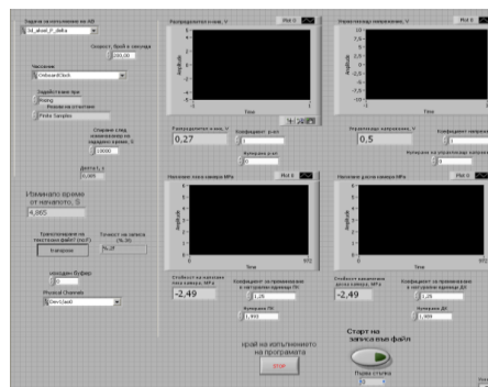
Фиг. 4.1. Потребителски интерфейс на разработения виртуален инструмент за експериментално определяне на силите от триене в пневматичен цилиндър
