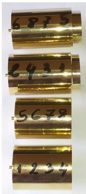
Фиг. 2.7 Експериментални образци за изследване на влиянието на броя на преходите и вида на работната схема
