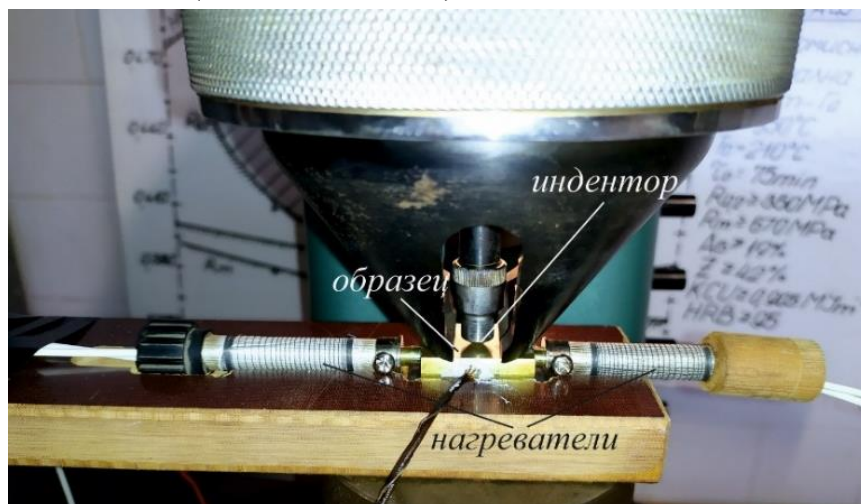
Фиг. 3.4 Експериментална установка за провеждане на indentation test
