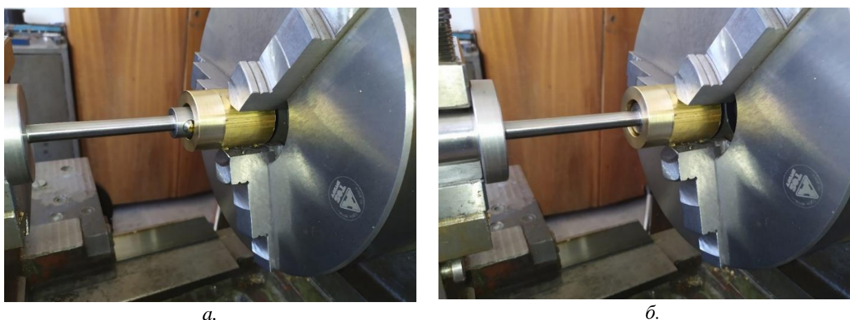
Фиг. 4.1 ДЗ на отворите на втулките а. позиция на инструмента преди въвеждането му в отвора; б. позиция на инструмента по време на процеса ДЗ
