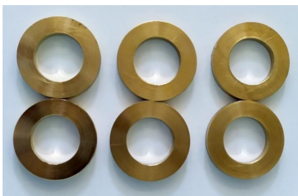
Фиг. 4.2 Втулки, използвани за експерименталните образци
