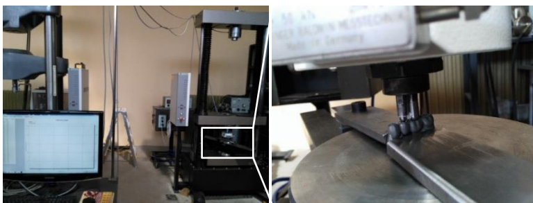
Фиг.2-15 Експеримент на огъване четиричленни дентални мостови конструкции.
