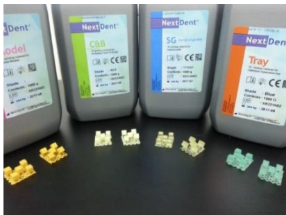
Фиг. 2-1 Кубични образци от различните видове пластмаси, изработени чрез 3D печат на стереолитографски принтер.
