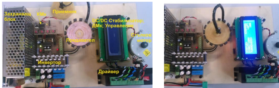
Фиг.4.37. Прототип на ротационна система за БПЕ с еднопосочна комуникация
