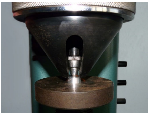
Фиг. 2.1 Експериментална установка за провеждане на "indentation test"
