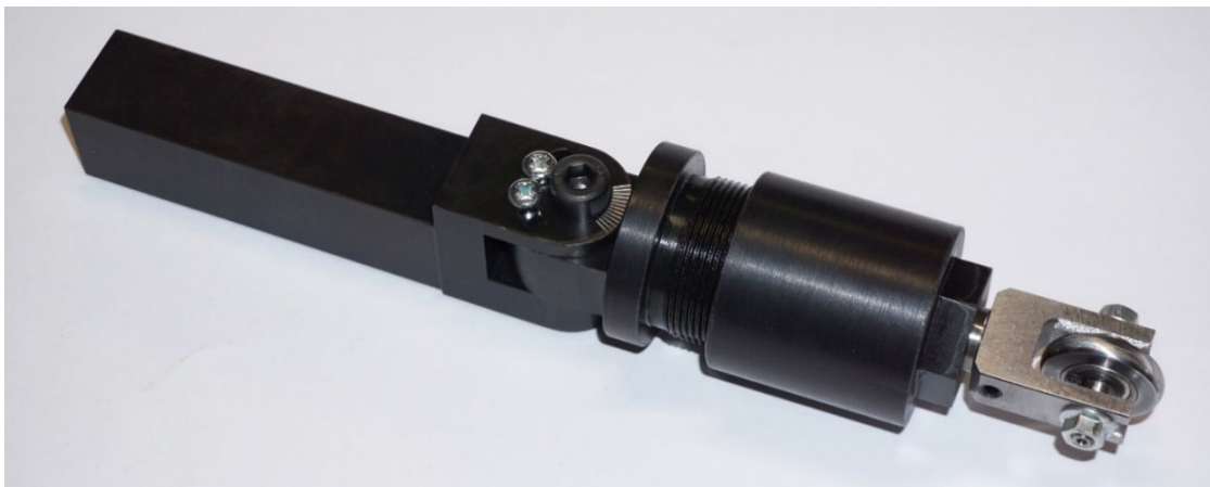
Фиг. 3.2. Общ вид на разработената конструкция на устройство за ППД с ТДР
