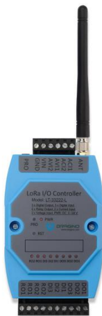
Фиг. 4.1. LoRaWAN базиран модул за управление и мониторинг.
