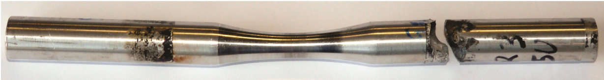
Фиг. 4.14. Разрушен образец в следствие на явлението контактна умора (fretting fatigue)
