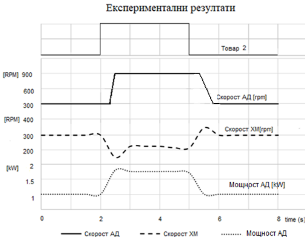
Фиг. 4.10. Експериментален преходен процес в електрохидравлична система с обемно регулиране чрез промяна на оборотите на АД с ЧИ и ПИД регулатор при увеличен степенчат товар.
